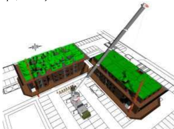
Figura 8 - Áreas de estoque, localização de elevadores cremalheiras e caminhão guindaste no estudo 4.
